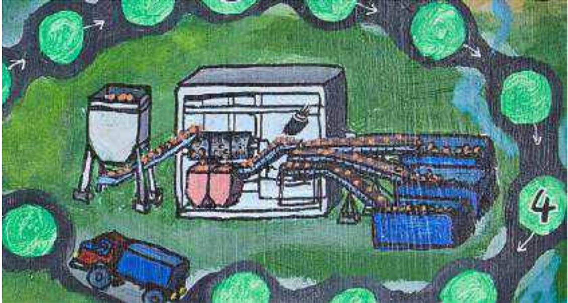
**Fluorit:** Im Sortierwerk wird der Fluorit nach Reinheit sortiert. Dabei stellen Kameras den Reinheitsgrad fest. Unterschiedliche Förderbänder verteilen die Steine auf verschiedene Container. Der reinste Fluorit eignet sich für die Herstellung von Linsen für Fotoapparate und von Schmuck.
