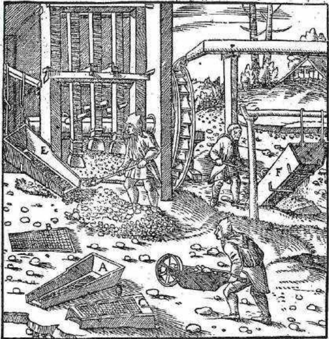
Hier siehst du einen weiteren Arbeitsschritt der **Erzaufbereitung**. Wir befinden uns im Waschwerk. Das Erz wurde mit Hilfe von Wasser gesiebt und sortiert. Bemale alle Menschen und Siebe, die du in dieser Darstellung finden kannst!
